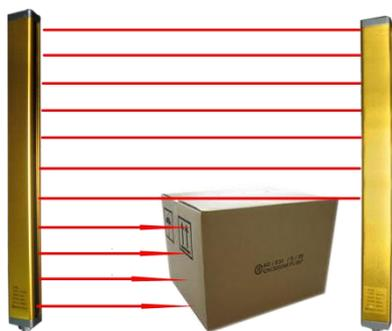
MYDZ 系列测量光幕由发光器和接收器组成, 发光器发出的光直射到接收器, 形成光幕系统。放置在发光器和接收器之间的目标物体将会阻挡一部分光线使其不能射到相应的接收器器件。MYDZ 系列测量光幕使用同步扫描来识别被挡的通道。首先一个发光器通道发出光脉冲而对应的接收器同时来寻找该脉冲, 当找到后即完成一个通道的扫描, 接着转向下一个通道, 直到所有的扫描都完成。当一个周期扫描完成后, 系统记录哪些通道通光, 哪些通道被遮挡, 根据系统定义输出一个信号, 该信号可以的模拟量信号, 也可以是开关量信号。
